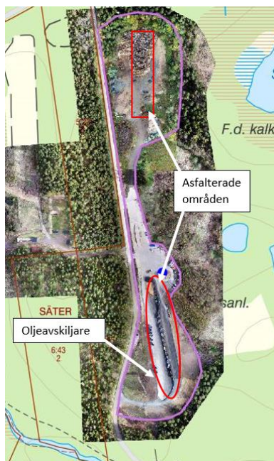
Figur 8 Rödmarkerade områden är hårdgjorda genom asfaltering. Observera att markeringen är ungefärlig. Dagvatten från delar av det nedre rödmarkerade området avleds till oljeavskiljare med utpekad placering. Kartkälla: Sätters kommun (bearbetad).
