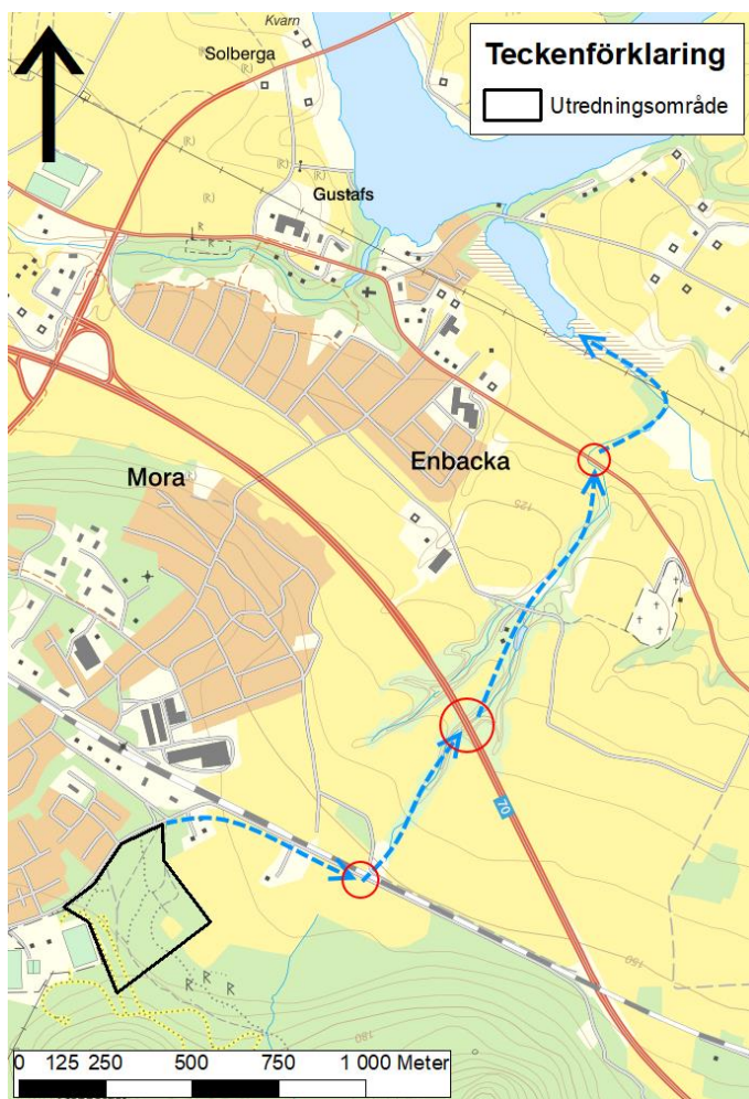
Figur 8. Antagen avledningsväg (blå pilar) för dagvatten från utredningsområdet. Tre passager (röda cirklar) behöver göras under järnvägen, väg 70 och Enbackavägen. Bakgrund: Terrängkartan från Lantmäteriets visningstjänst.
